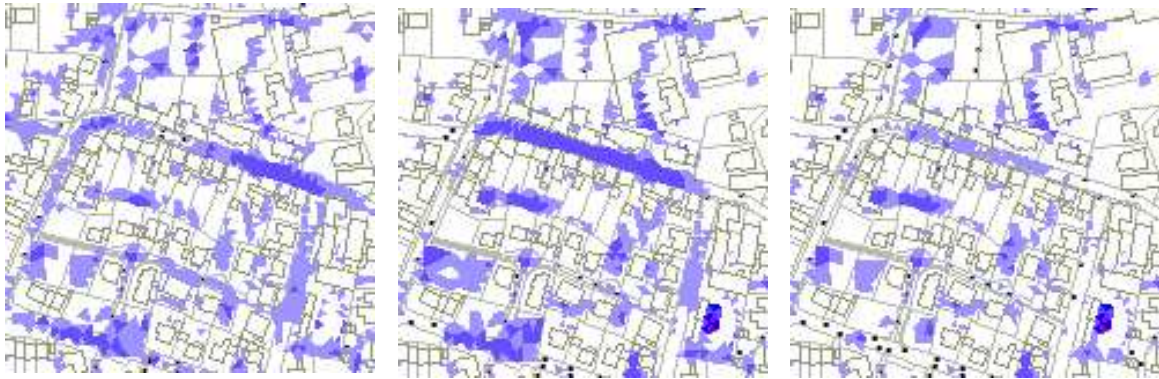
Abbildung 21: Wasserstände 10, 40 und 90 Minuten nach Regenbeginn
